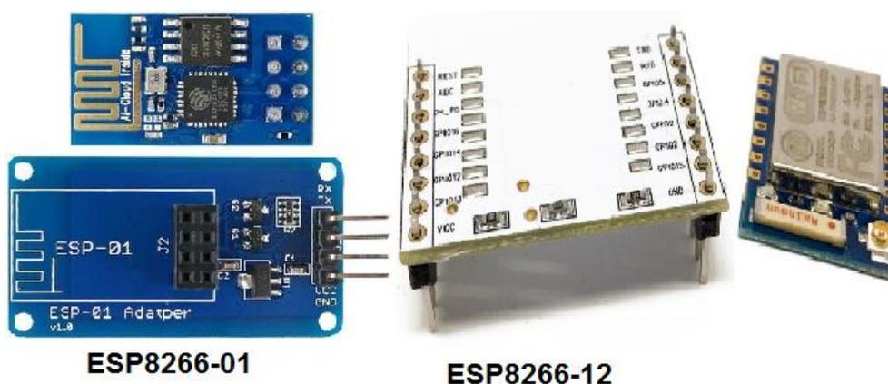
**Figura 9. Comparativa ESP8266-01 vs ESP8266-12**
