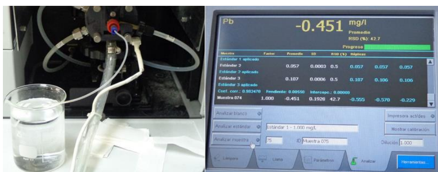
Figura 83. Toma de la Muestra y Resultado de la Medición Plomo Pb
