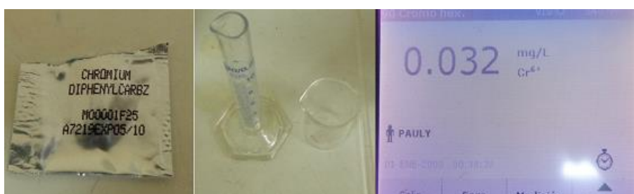
Figura 80. Reactivo ChroqmiumVer Diphenylcarbz, Probeta de 10 ml y Medición del Cromo Hexavalente
