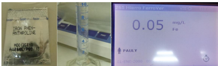
Figura 79. Reactivo FerroVer, Probeta de 10 ml y Medición del Hierro Total
