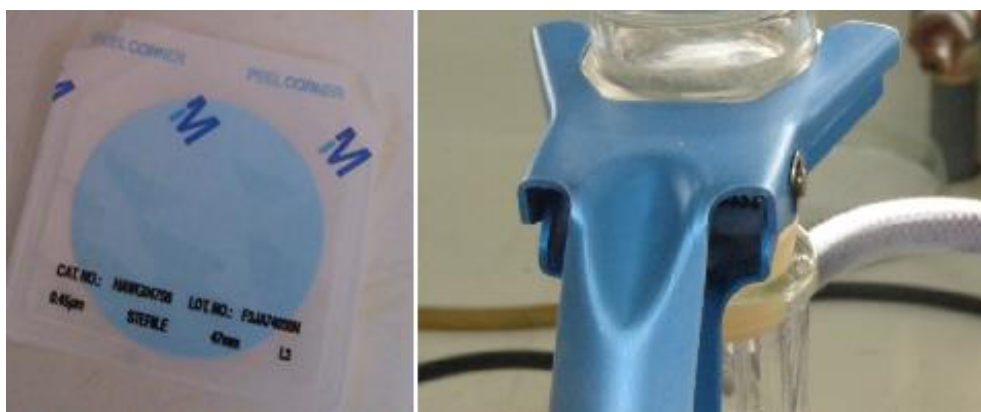
Figura 88. Membrana filtrante y Colocación del matraz y la unidad de filtración
