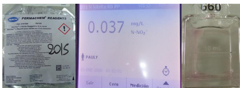
Figura 78. Reactivo NitriVer y Medición del Nitrato NO 2
