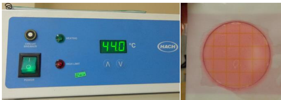
Figura 87. Incubación y Placa transcurrida las 24 horas
