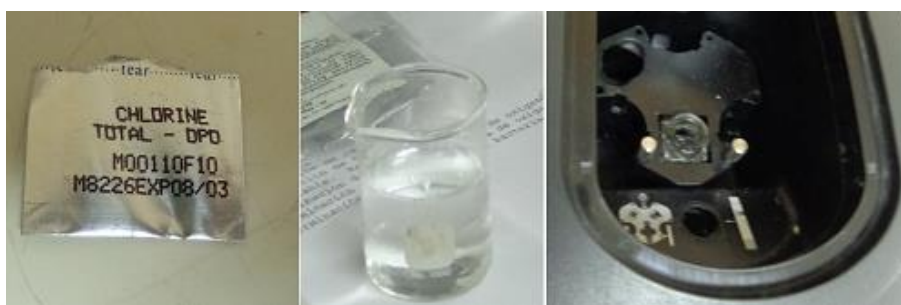
Figura 81. Reactivo ChlorineVer, Muestra de 10 ml y Medición del Cloro Total
