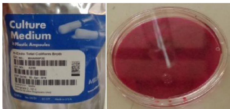
Figura 92. Cultivo m-Endo Total Coliform Broth y Caja petri saturada
