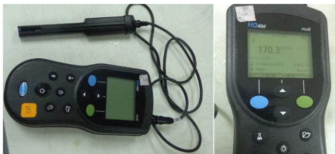
Figura 73. Medición de la conductividad
