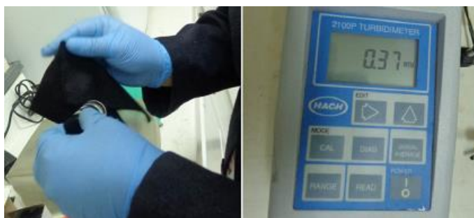
Figura 74. Recubrimiento con aceite de silicona y Medición de la Turbidez
