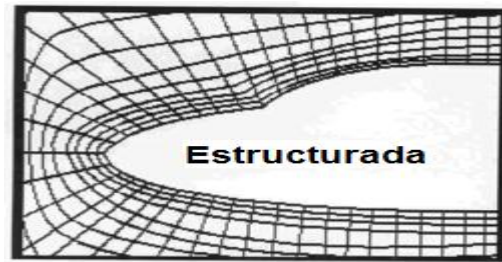
Figura 24 Ejemplo de malla estructurada
