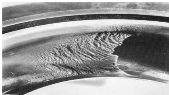
Figura 16 Daño de los álabes de un rodete producto de la cavitación
