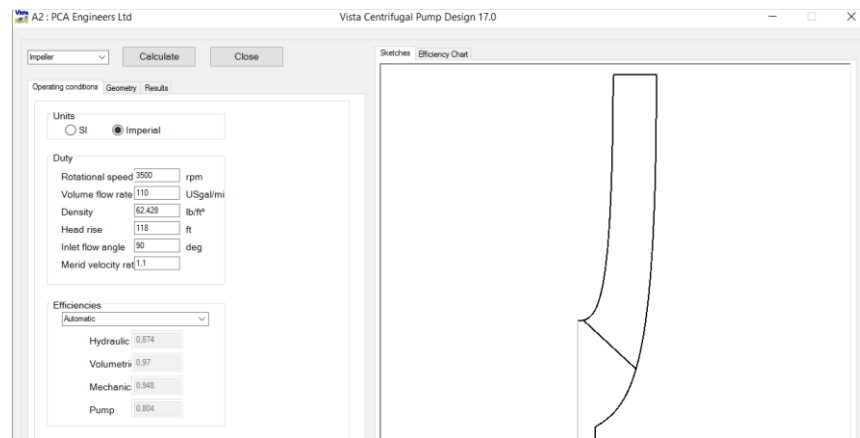
Figura 52 Diseño 1D impulsor bomba centrífuga
