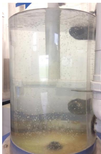
Figura 88 Tanque de descarga bajo régimen de cavitación
