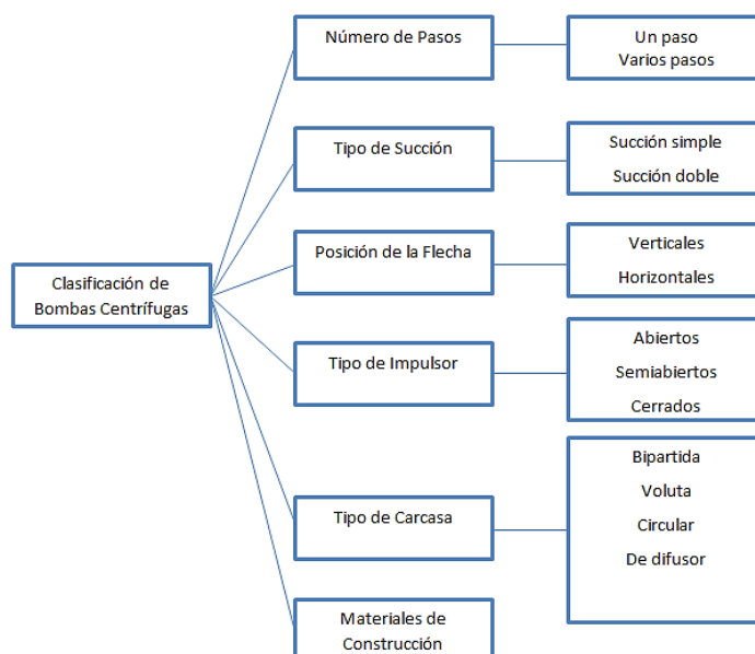
Figura 4 Clasificación Bombas Centrífugas
