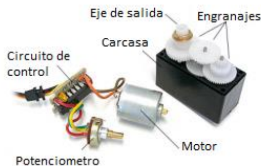
Figura 9. Partes de un servomecanismo típico
