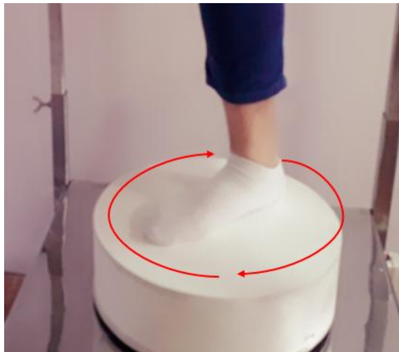
Figura 50. Prueba de funcionamiento de la plataforma giratoria.
