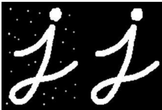
Figura 15. Ejemplo del resultado al aplicar la operación Opening
