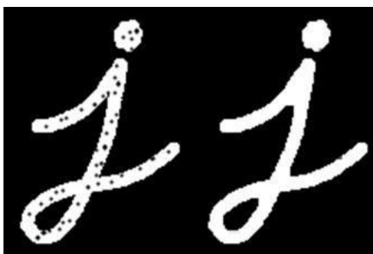
Figura 16. Ejemplo del resultado al aplicar la operación Closing
