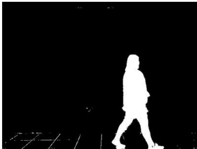
Figura 25. Persona caminando, aplicación de la técnica substracción de fondo para extraer la silueta.
