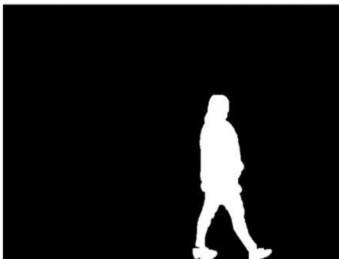
Figura 27. Silueta de la persona caminando, aplicación de la operación morfológica OPENING
