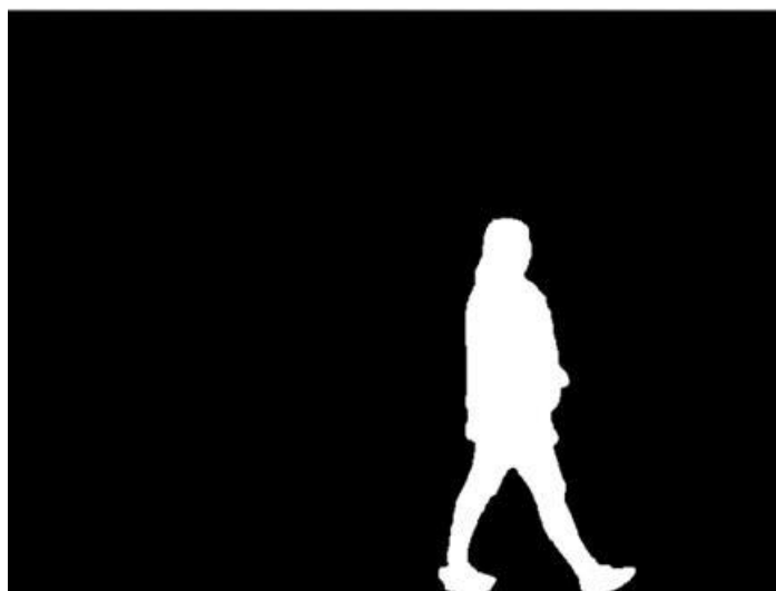
Figura 29. Silueta de la persona caminando, aplicación de la operación morfológica DILATION
