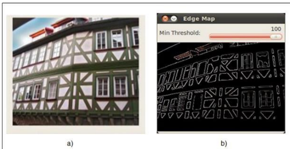
Figura 11. a) Imagen original. b) Aplicación de detección de bordes (Canny)
