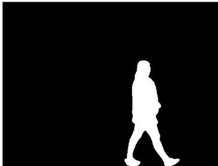
Figura 30. Aplicación del filtro medianblur para crear un suavizado en la silueta
