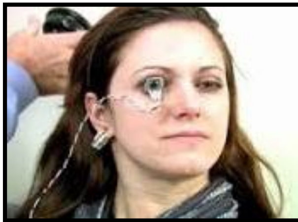
Figura 3 Sensor ocular mediante potenciales eléctricos
