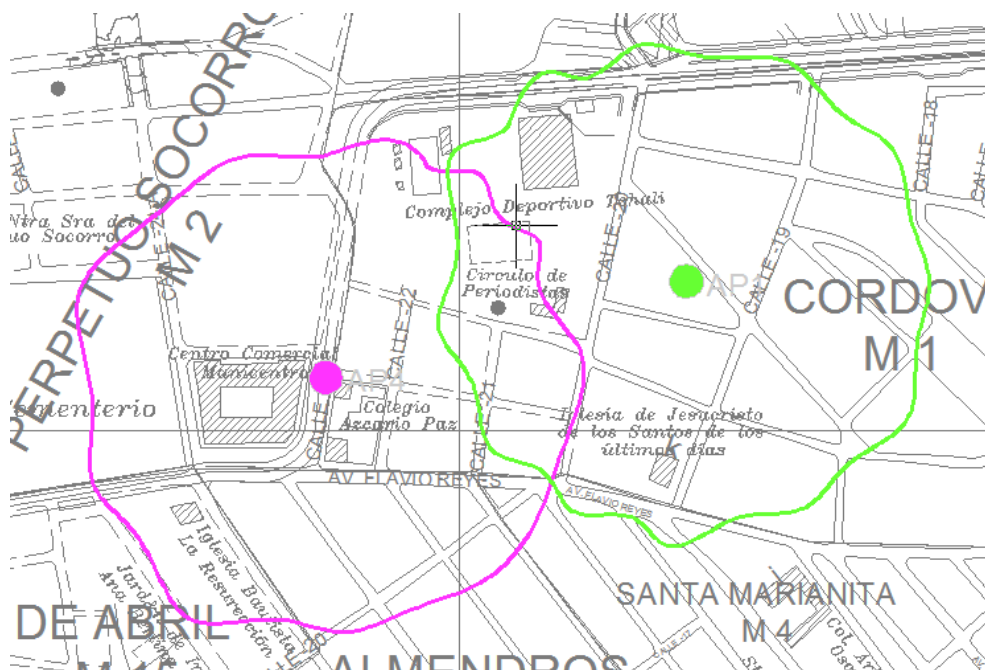
Figura 4. 21 Solapamiento de dos nodos
