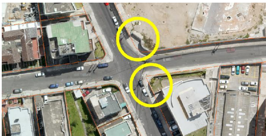
Figura 65. Diferencias visuales Catastro DMQ – Ortofotografía UAV
