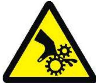
Figura 3: Señal de factor de riesgo mecánico
