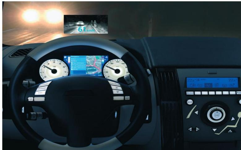
**Figura 3.** Sistema de visión en el infrarrojo.
