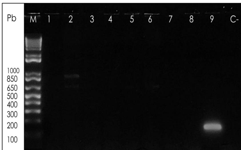
**Figura 15.** Electroforesis en gel de agarosa al 1.5% donde se observan los productos de PCR con los cebadores para Panpestivirus de las muestras sanguíneas. 1: 121, 2:577, 3: 727, 4: 1096, 5:522, 6:542, 7:2055, 8:S.A, 9: Control positivo, C-: control negativo M: Marcador molecular 1 kb Plus DNA Ladder
