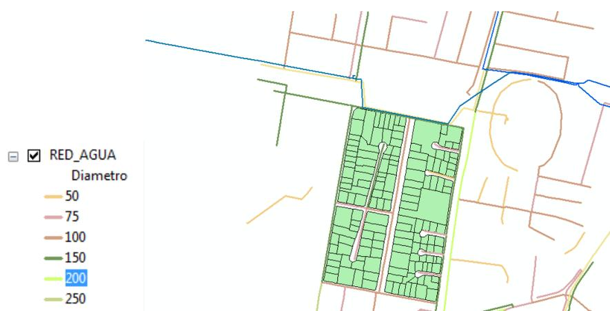
**Figura 29. Representación de los diámetros de las tuberías en la zona piloto**
