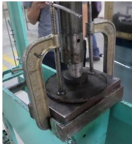
**Figura 33:** Prensado de la mezcla dentro del molde
