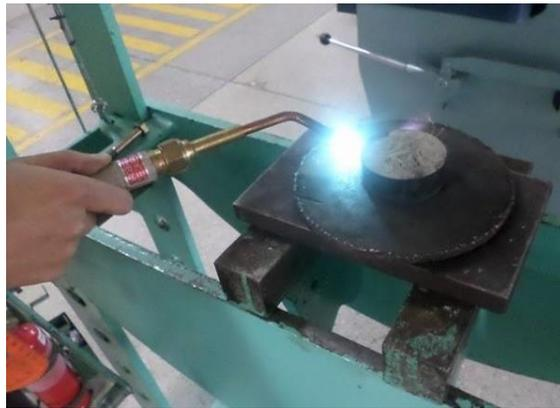
**Figura 32:** Aplicación de calor al molde con la ayuda de un soplete
