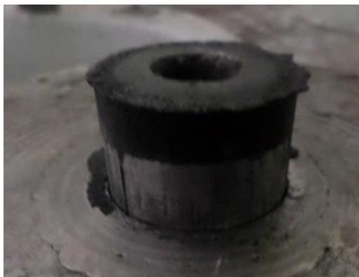
**Figura 34:** Probeta o pastilla desmoldada
