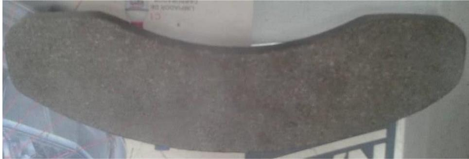
**Figura 35:** Plancha de pastilla de freno semimetálica.
