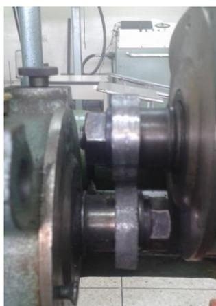
**Figura 40:** Pastilla de freno semimetálica comercial montada en la máquina Amsler.
