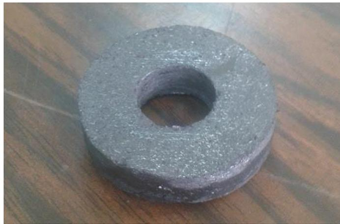
**Figura 36:** Pastilla de freno semimetálica con geometría para realizar el ensayo de desgaste.
