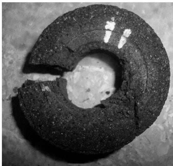
**Figura 41:** Probeta fabricada con resina fenólica y polvo de carbón.
