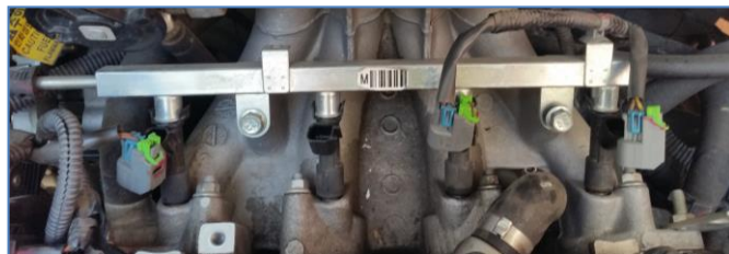
Figura 148. Desconexión de inyectores.
