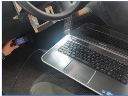
Figura 139. Conexión OBD-II y puerto USB
