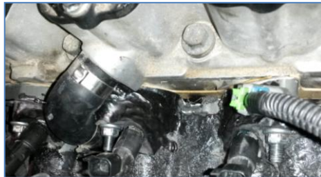
Figura 166. Múltiple PLA instalado.
