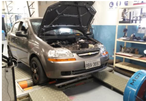
Figura 170. Conducción del vehículo en el dinamómetro.
