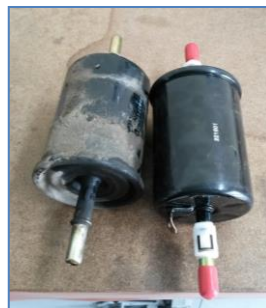
Figura 88. Filtros de combustible viejo y nuevo
