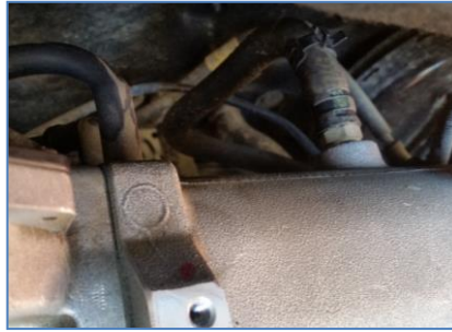
Figura 150. Mangueras de vacío.
