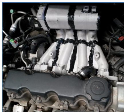
Figura 168. Montaje del múltiple PET.
