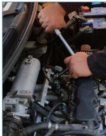
Figura 149. Aflojado de los pernos del riel de combustible.
