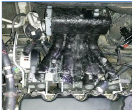
Figura 160/ Múltiple PLA para el montaje.
