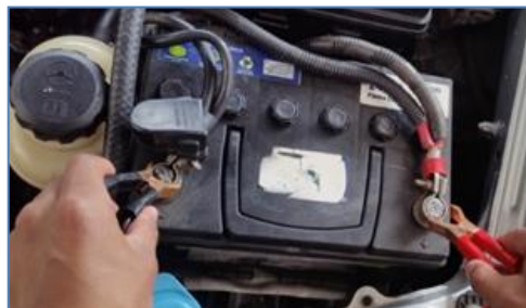
Figura 124. Conexión del módulo de rpm la batería
