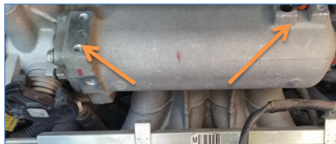
Figura 146. Ubicación del sensor MAP y sujetador del cable de aceleración.
