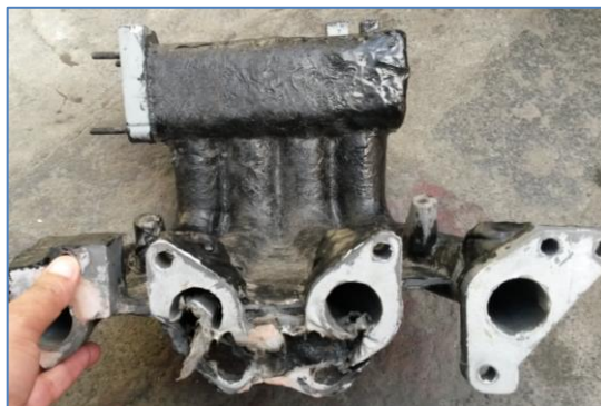
Figura 167. Deformación del múltiple PLA en los cilindros dos y tres.
