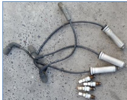
Figura 90. Cables y bujías viejos
