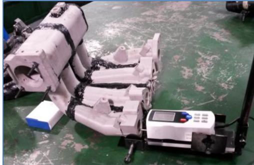
Figura 174. Rugosímetro y pieza a medir bien fijadas
