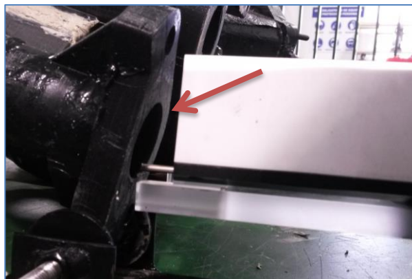
Figura 173. Superficie y punta palpadora en contacto
