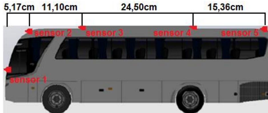
Figura 96 Ubicación y distancia de los sensores en el Bus, vista lateral
