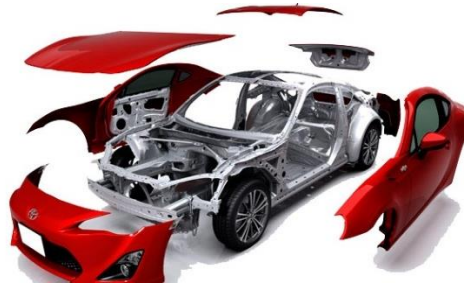
Figura 17 Carrocería autoportante o compacta
