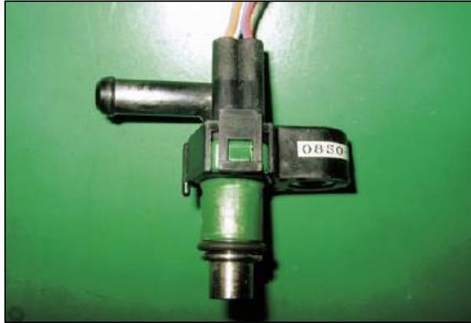
**Figura 13. Inyector de la motocicleta Yamaha FJR1300**
