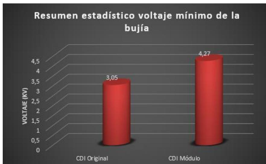
**Figura 90.** Resumen estadístico del voltaje mínimo de la bujía.
