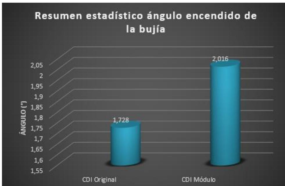
**Figura 93. Resumen estadístico del ángulo de encendido de la bujía.**
