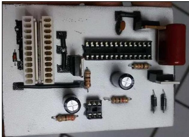
**Figura 59. Placa terminada con los elementos montados.**
