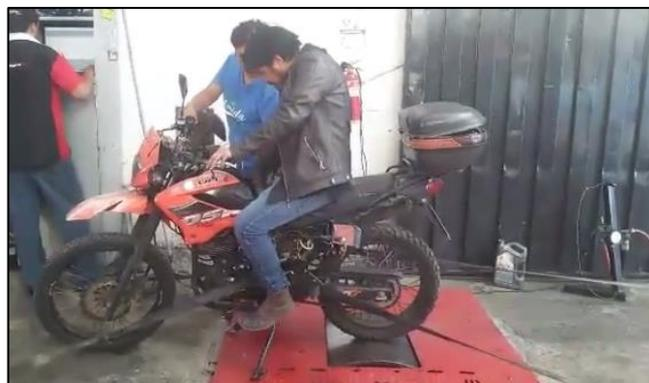
**Figura 67. Ejecución de la medición de torque y potencia**
