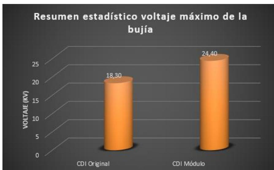
**Figura 89.** Resumen estadístico del voltaje máximo de la bujía.
