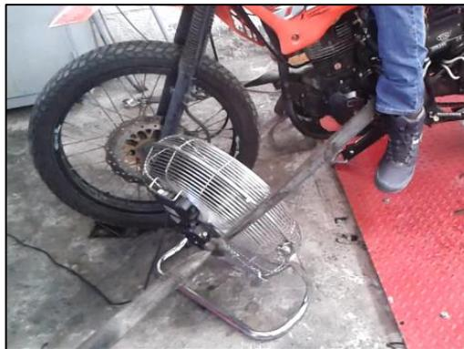
**Figura 65. Ventilador para controlar la temperatura del motor.**
