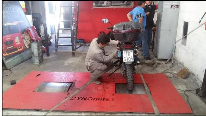
**Figura 64. Colocación cintas de seguridad para la prueba de Torque y potencia.**
