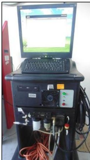
**Figura 69. Analizador de gases-opacómetro CARTEK**
