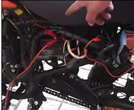
**Figura 71. Conexión medidor RPM a la batería.**
