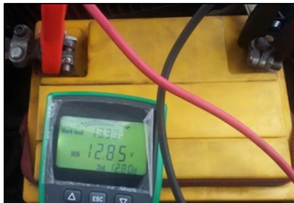
Figura 75. Resultado de la prueba de consumo de corriente
