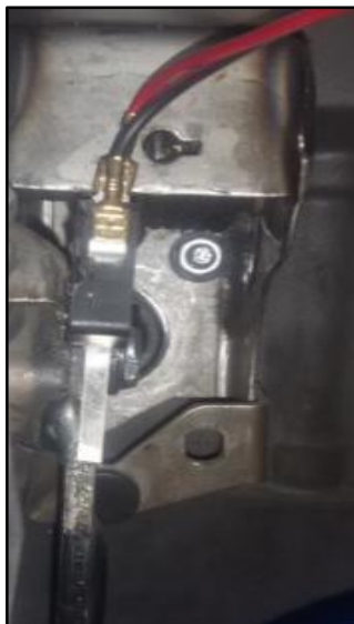
Figura 44. Ubicación del final de carrera del embrague
