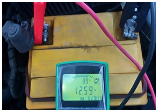
Figura 74. Resultado de la prueba de vida útil de la batería
