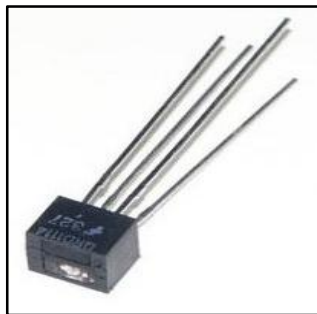
Figura 18. Sensor óptico de posición
