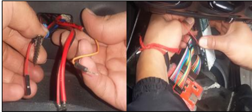
Figura 46. Montaje y conexión del microcontrolador
