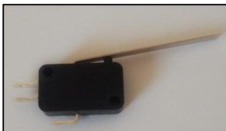
Figura 19. Sensor mecánico de posición
