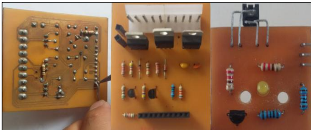
Figura 43. Proceso de suelda y placas finalizadas
