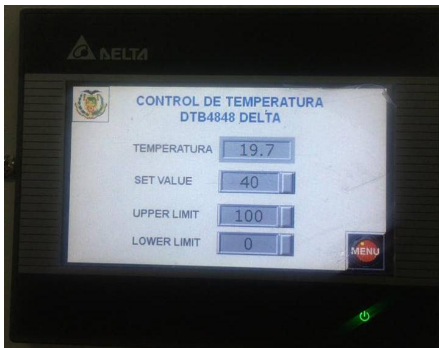
Figura 177 Asignación del Set Point y de los límites (superior e inferior) del Controlador de temperatura
