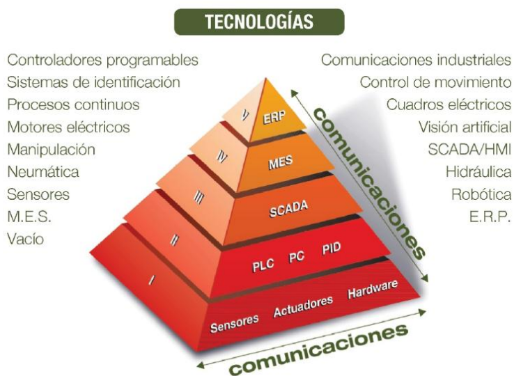
Figura 2: Pirámide de la automatización industrial Fuente: (SMC, 2016)
