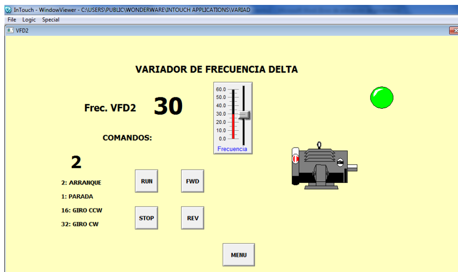
Figura 188 Pantalla de control del VFD2
