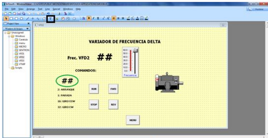
Figura 149 Escritura de ## para acceso a registros Modbus
