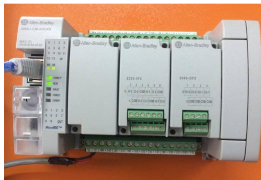
Figura 88 Conexión del PLC AB Micro850
