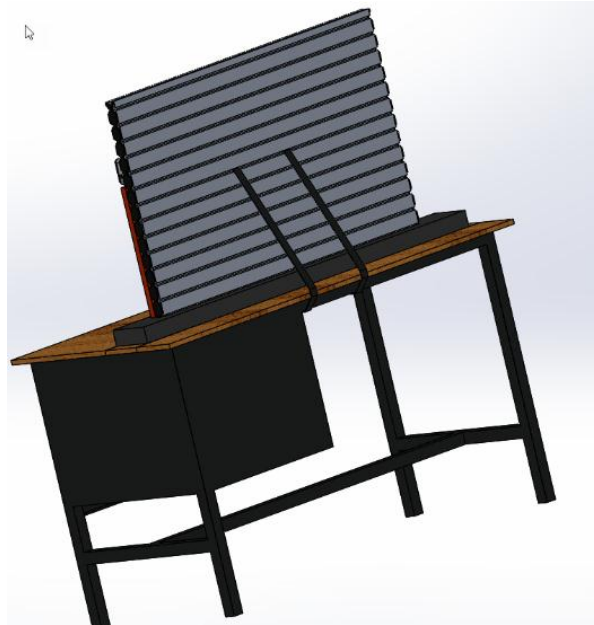
Figura 59 Soportes de acero estructural del Perfil de aluminio
