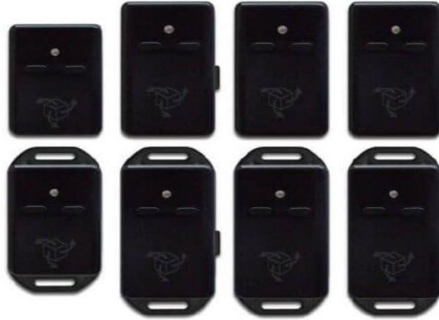
Figura 2: Sensores del paquete 3-Space Mocap. Fuente: (yostlabs, Yost Labs Inc, 2016)
