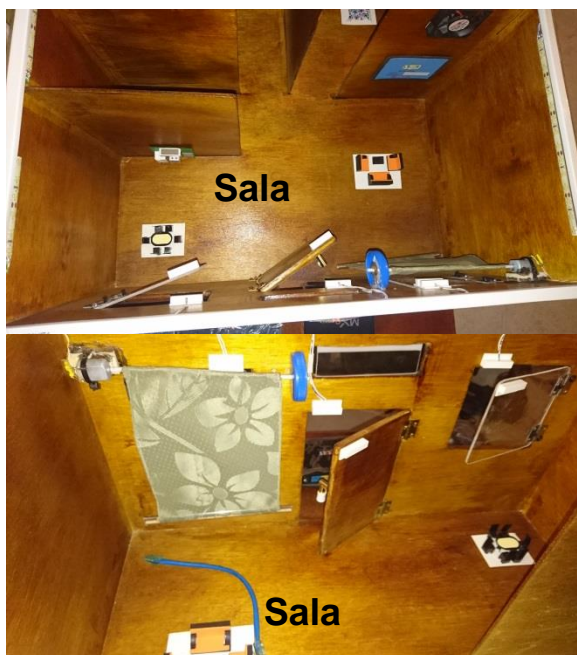
Figura 78. Luces, persiana, ventilador y sensores en maqueta
