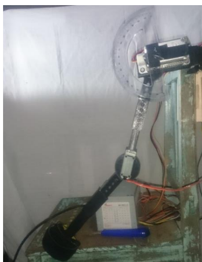
Figura 102 Pruebas de medición de los ángulos ejecutados vs ángulos medidos del hombro
