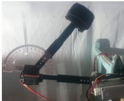
Figura 104. Pruebas de medición de los ángulos ejecutados vs ángulos medidos del codo
