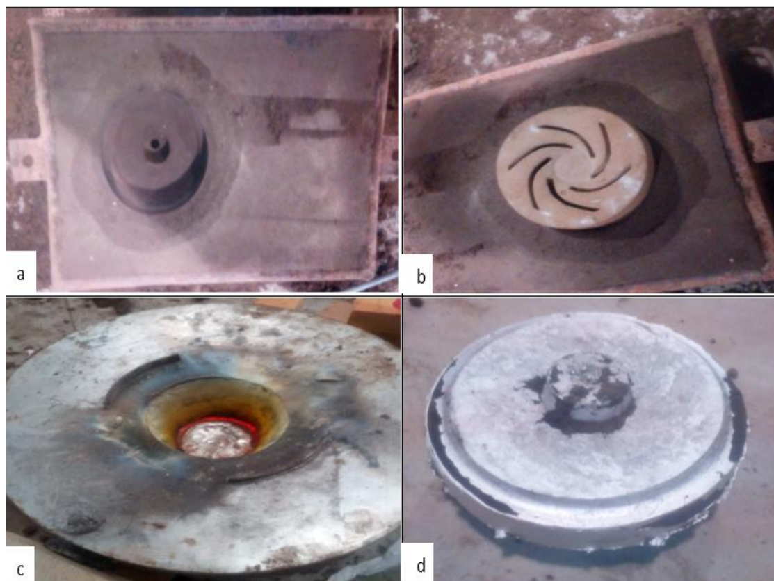
Figura 40 Proceso de fundición: a) moldeo de la cavidad externa, b) ubicación del núcleo, c) fusión del aluminio, d) producto en bruto del impulsor.
