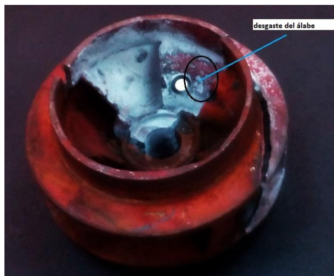
Figura 23 Rodete deteriorado por el desgaste.
