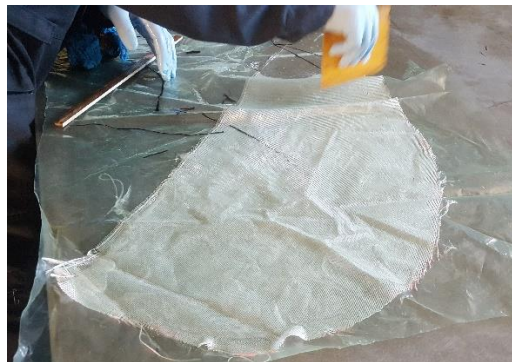
Fig. 48 Mezcla de la resina epóxica con la fibra de vidrio Fuente: (Centro de Investigación y Desarrollo FAE, 2017)
