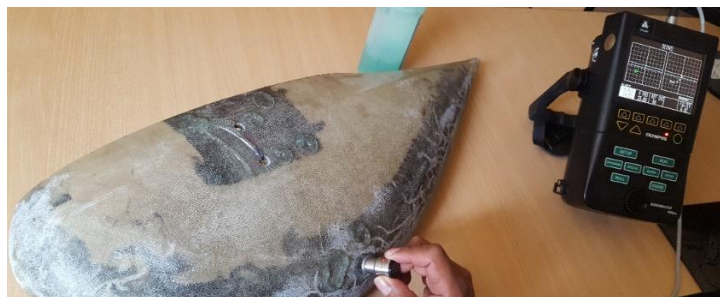
Fig. 62 Ensayo no destructivo por ultrasonido del carenado
