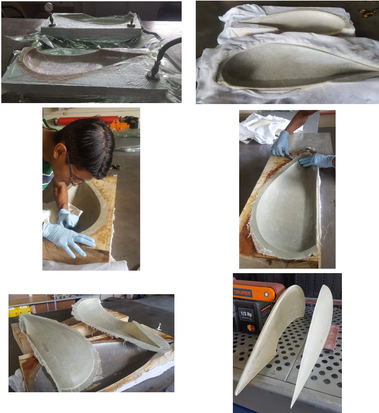
Fig. 50 Proceso de curado y desmolde de los carenados Fuente: (Centro de Investigación y Desarrollo FAE, 2017)
