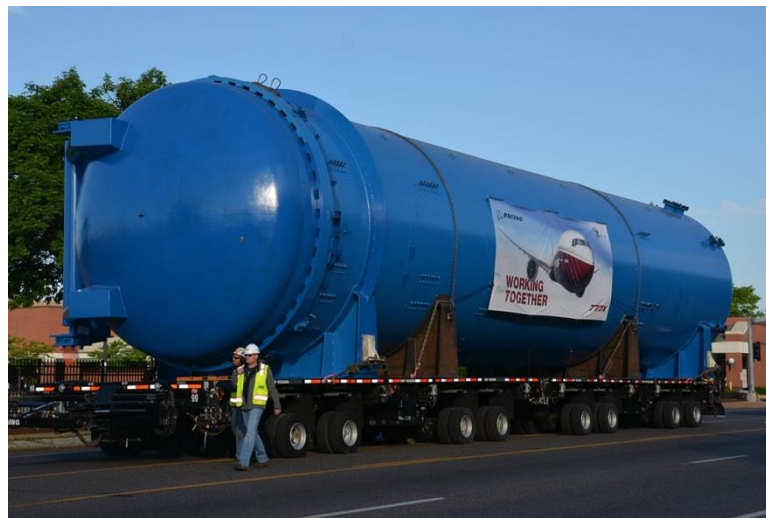
Fig. 2 Autoclave para fabricación de alas avión Boeing 777X
