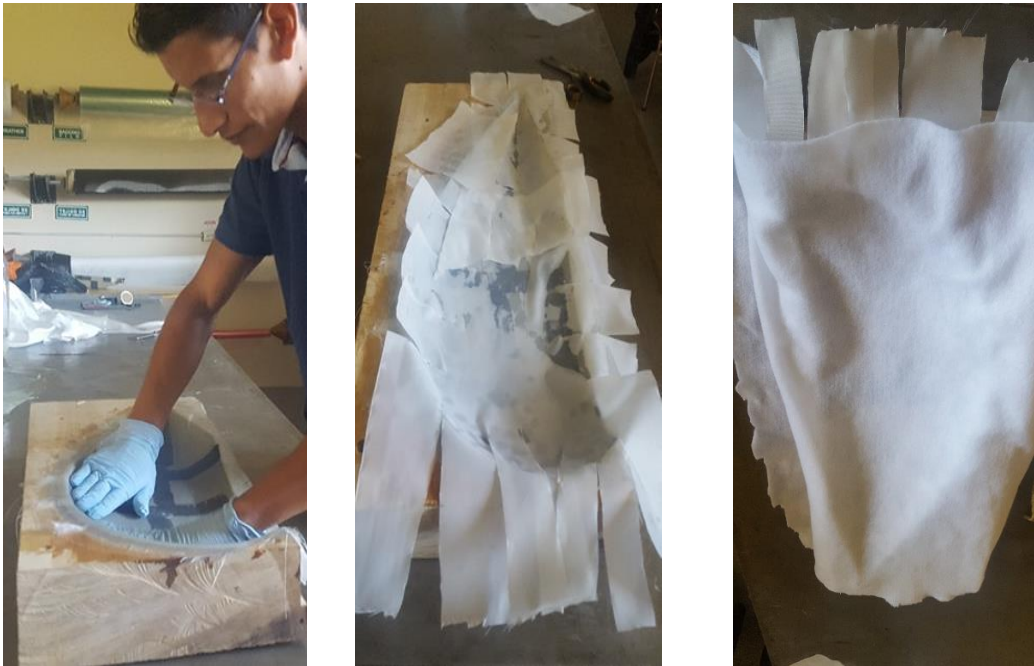
Fig. 49 Proceso de laminado, colocación peel plies y manta de aireación
