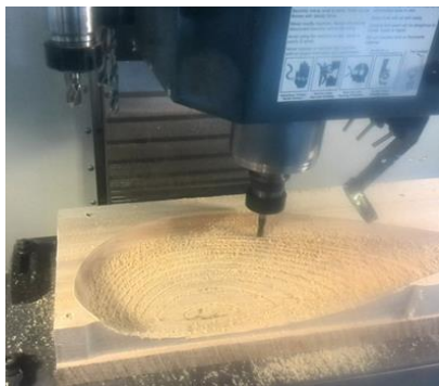
Fig. 46 Proceso de manufactura del molde en el CNC Fuente: (Centro de Investigación y Desarrollo FAE, 2017)
