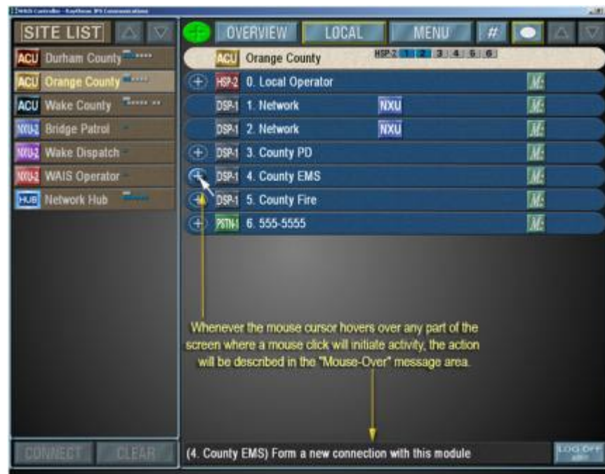
Figura 3.10 Inicio de una conexión cruzada Local – Paso1
