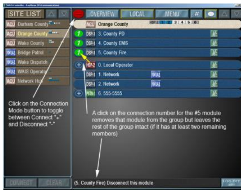
Figura. 3.20. Cortar conexiones en la Vista Local
