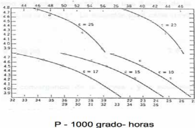
Fig. 2.10 Determinación gráfica de la constante C en el parámetro Larsom y Miller para un Nimonic 80A (8) .
