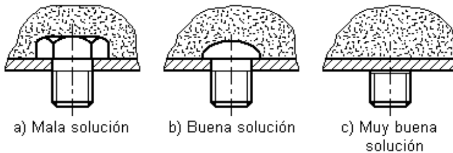
Fig. 4.2.25. Fijación de tornillos en los soportes elastoméricos.
