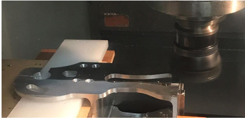
Figura 59 Proceso de acabado de la estructura
