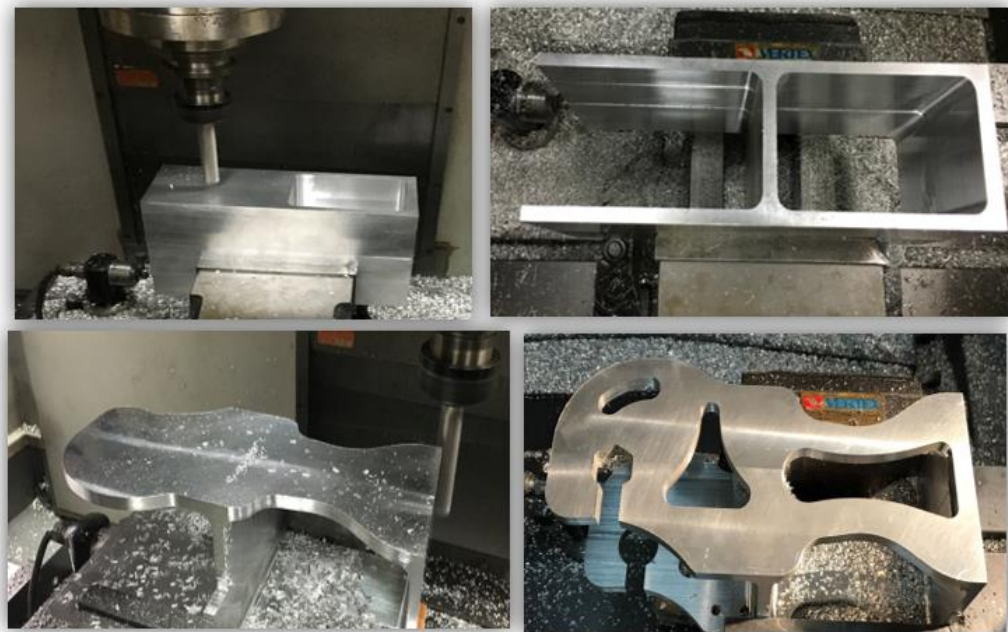
Figura 58 Mecanizado de la estructura.
