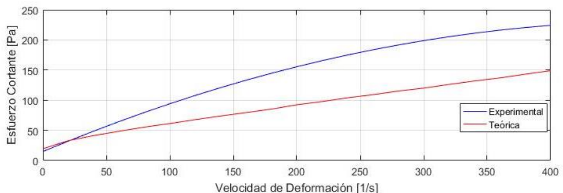
Figura 24 Comparación de la curva experimental con teórica a 40 [^{\circ}C] y 0 [mT] .
