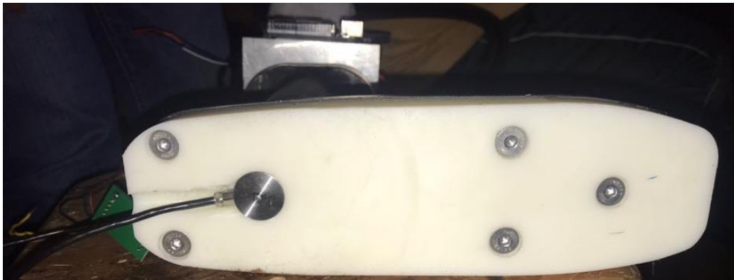
Figura 66 Celda de carga instalada.
