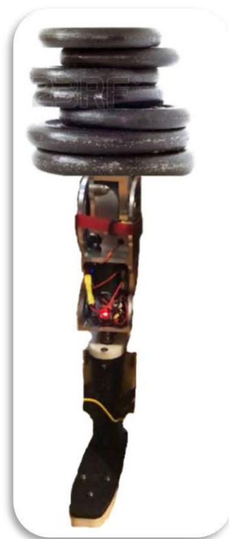
Figura 81 Pruebas del prototipo de prótesis a distintas cargas
