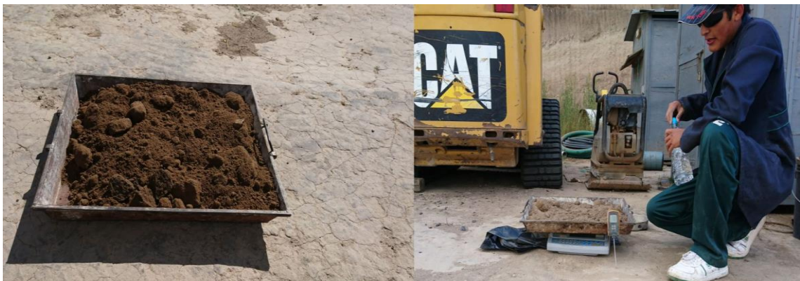
Figura 58 Ensayo de evaporación
