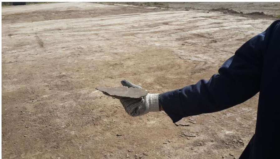
Figura 14 Efecto de Laminación en suelo tipo ML
