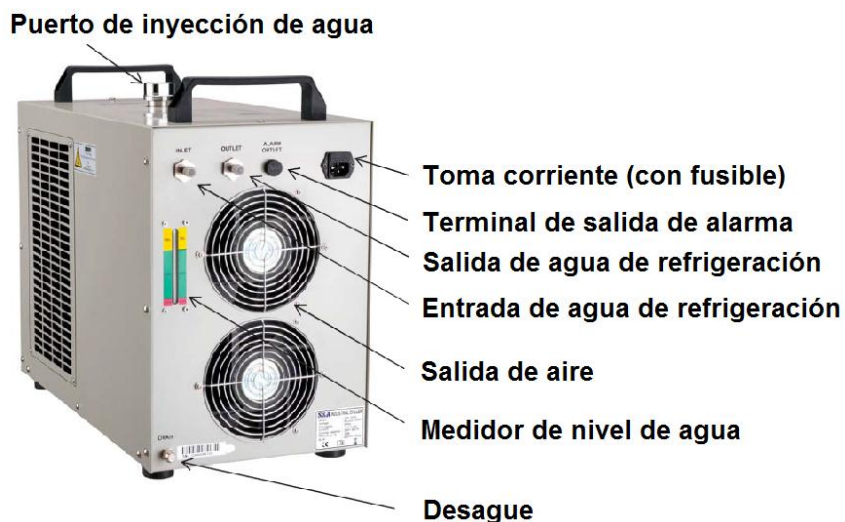
Figura 10. Parte posterior del enfriador industrial
