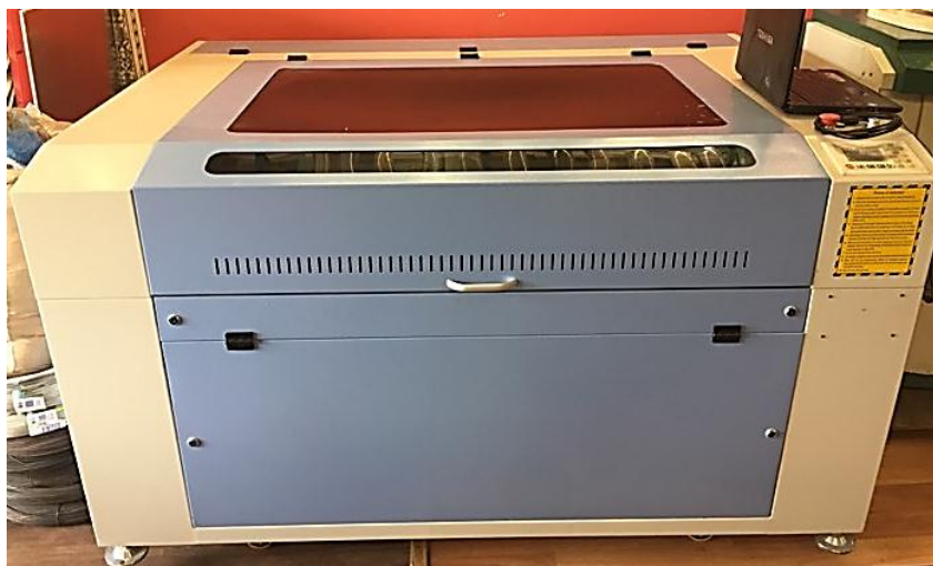
Figura 26. Vista frontal de la máquina con sistema automático de corte y grabado láser
