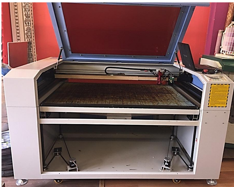
Figura 25. Sistema automático de corte y grabado con módulo láser de diodos
