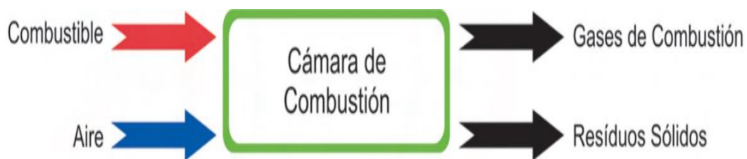
Figura 3. Esquema de funcionamiento de una Caldera.
