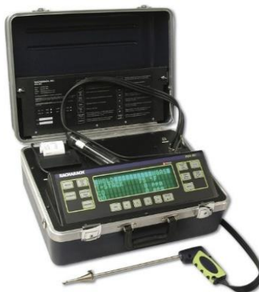
Figura 7. Analizador de gases de combustión. Fuente: (Bacharach)
