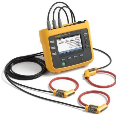
Figura 6. Analizador de red trifásica FLUKE 1730. Fuente: (FLUKE, 2006)
