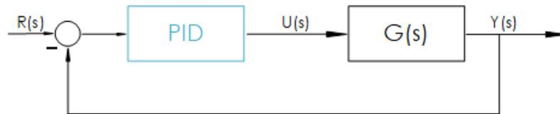
**Figura 12. Diagrama de bloques de la estructura del PID**
