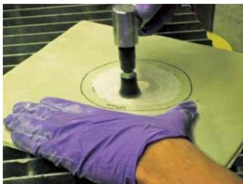
**Figura 31 Lijado cónico del área de reparación**
