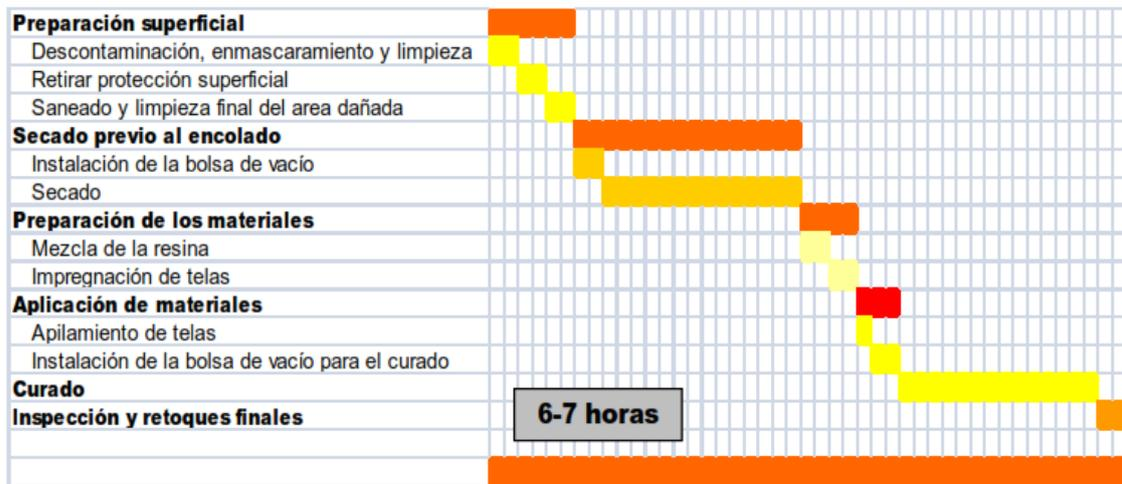
**Figura 27 Tareas y tiempo de una reparación cosmética típica**
