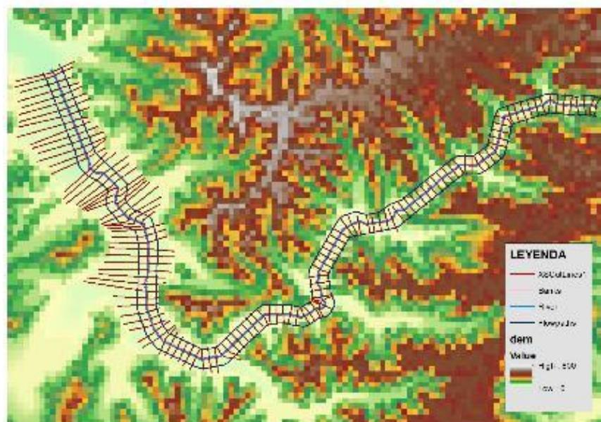
**Figura 56.** Secciones transversales creadas en el tramo de estudio del río Portoviejo utilizando la extensión Hec-GeoRAS
