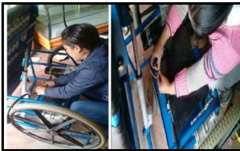
Figura 65. Acoplamiento del sistema eléctrico en el bipedestador
