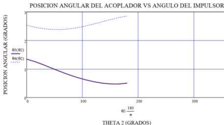
Figura 27. Desplazamiento angular del eslabón 3
