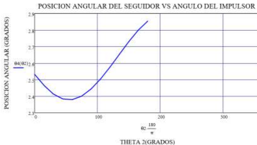
Figura 26. Desplazamiento angular del eslabón 4
