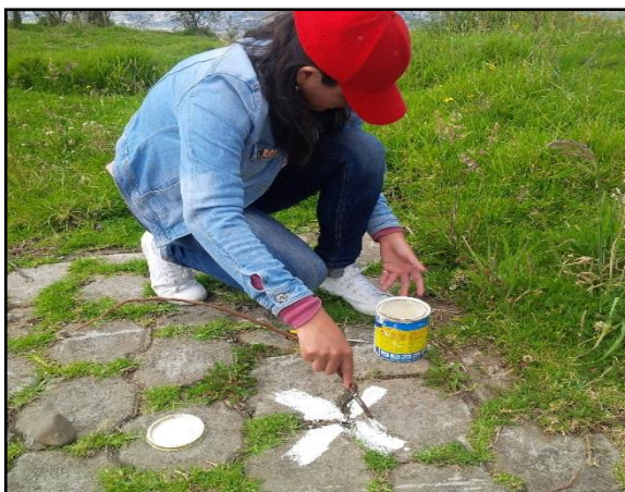
Figura 25. Señalización de los puntos de control fotogramétrico en el terreno
