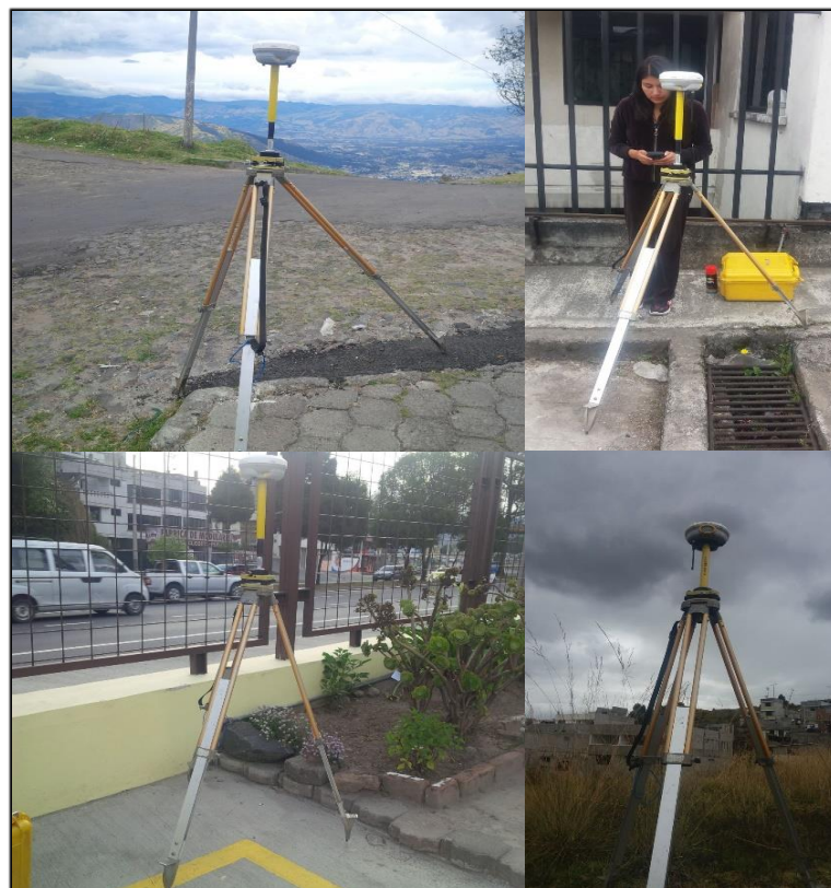
Figura 27. Toma de puntos de control fotogramétrico
