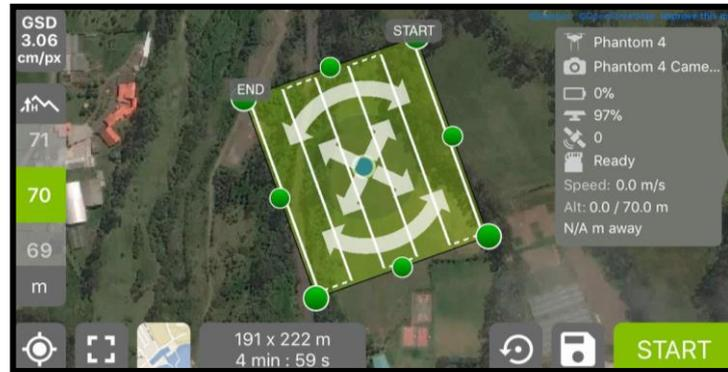
**Figura 21:** Líneas de Vuelo en Pix4D Capture
