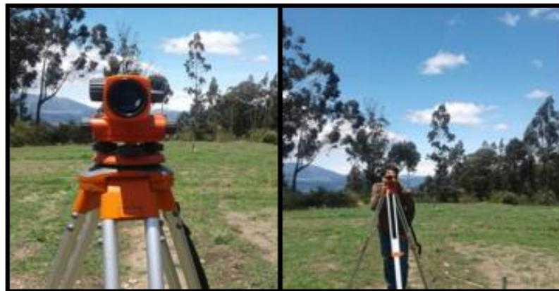
**Figura 20:** Nivelación Geométrica
