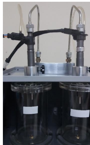
Figura 63 Inspección general del montaje de inyectores
