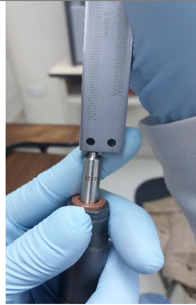
Figura 85 Medición de la punta del inyector a los orificios
