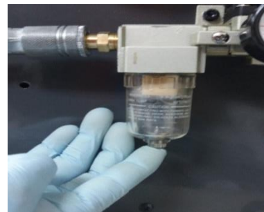
Figura 44 Trampa de agua
