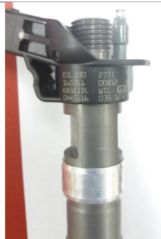
Figura 105 Limpieza de inyectores
