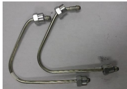
Figura 46 Cañerías de conexión
