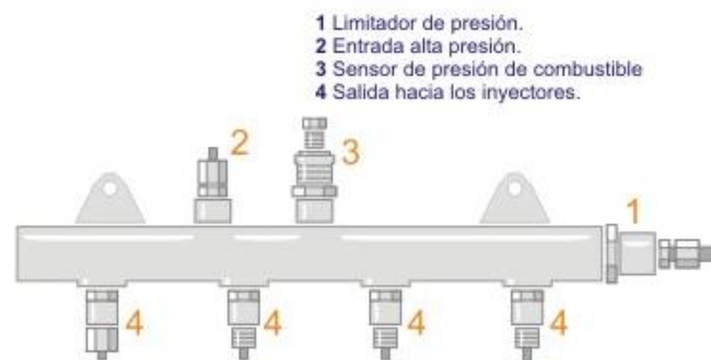
Figura 8 Riel de inyectores
