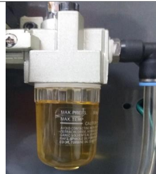
Figura 43 Depósito de lubricante
