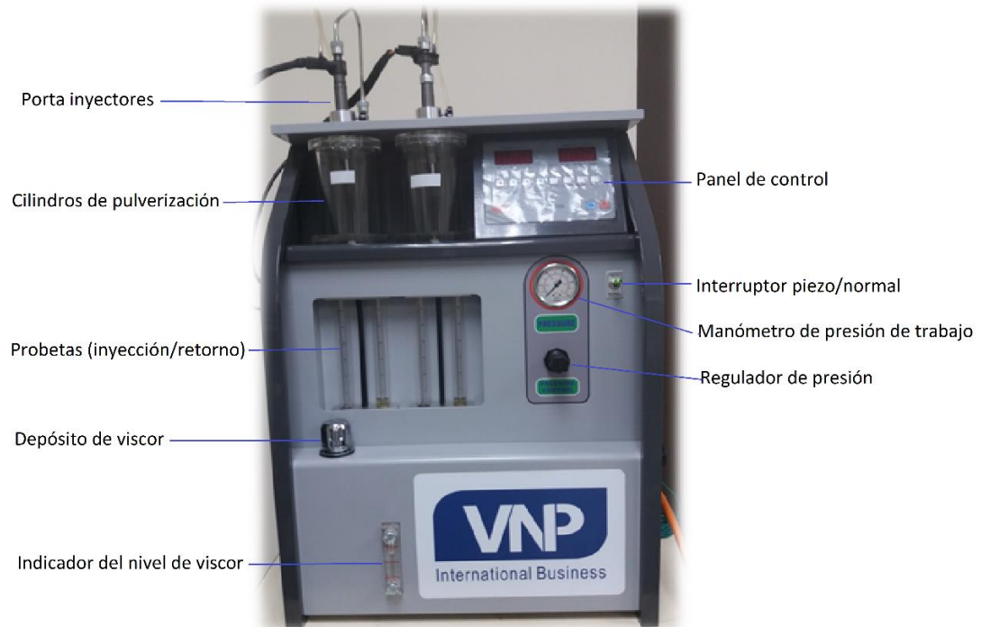
Figura 29 Banco de pruebas VNP V-3500
