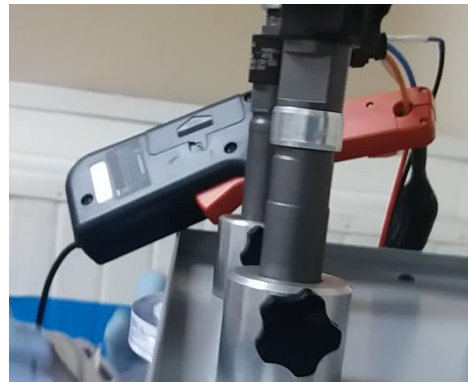
Figura 79 Conexión de la pinza amperimétrica
