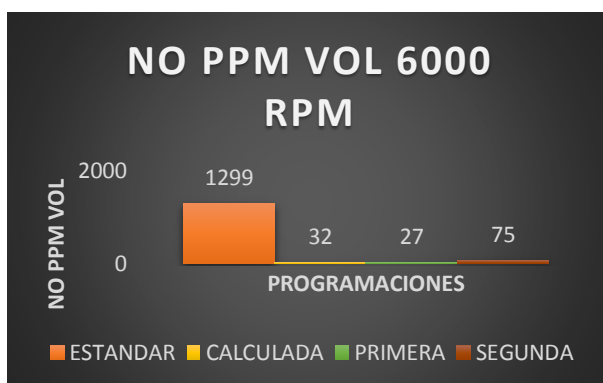
Figura 180 Emisiones de gases NO ppm 6000 RPM.
