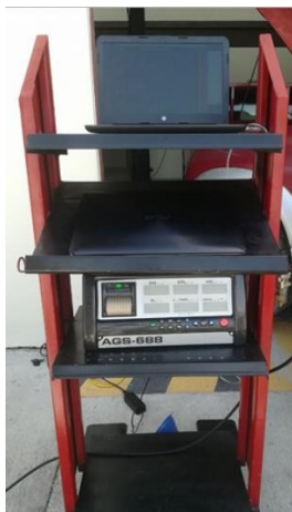
Figura 158 equipo analizador de gases.
