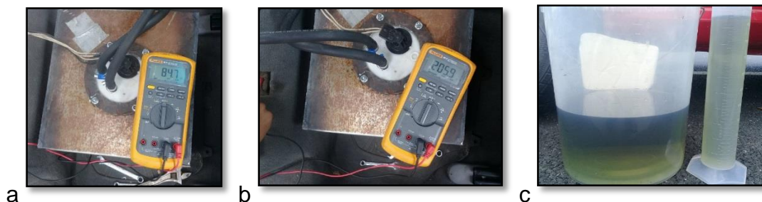
Figura 132 Prueba 1 ECU original, a) y b) Variación de resistencia, c) Variación de combustible.
