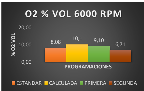
Figura 177 Emisiones de gases O2 6000 RPM.
