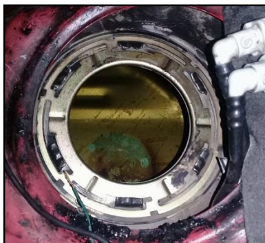
Figura 53 Ubicación bomba de combustible.
