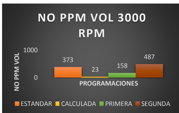
Figura 179 Emisiones de gases NO ppm 3000 RPM.
