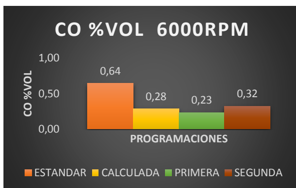
Figura 168 Emisiones de gases CO% VOL 6000 RPM.
