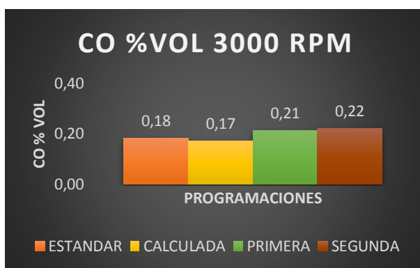
Figura 167 Emisiones de gases CO% VOL 3000 RPM.
