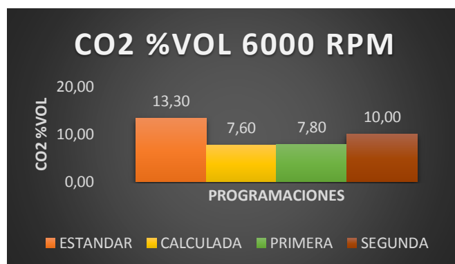
Figura 171 Emisiones de gases CO2% VOL 6000 RPM.
