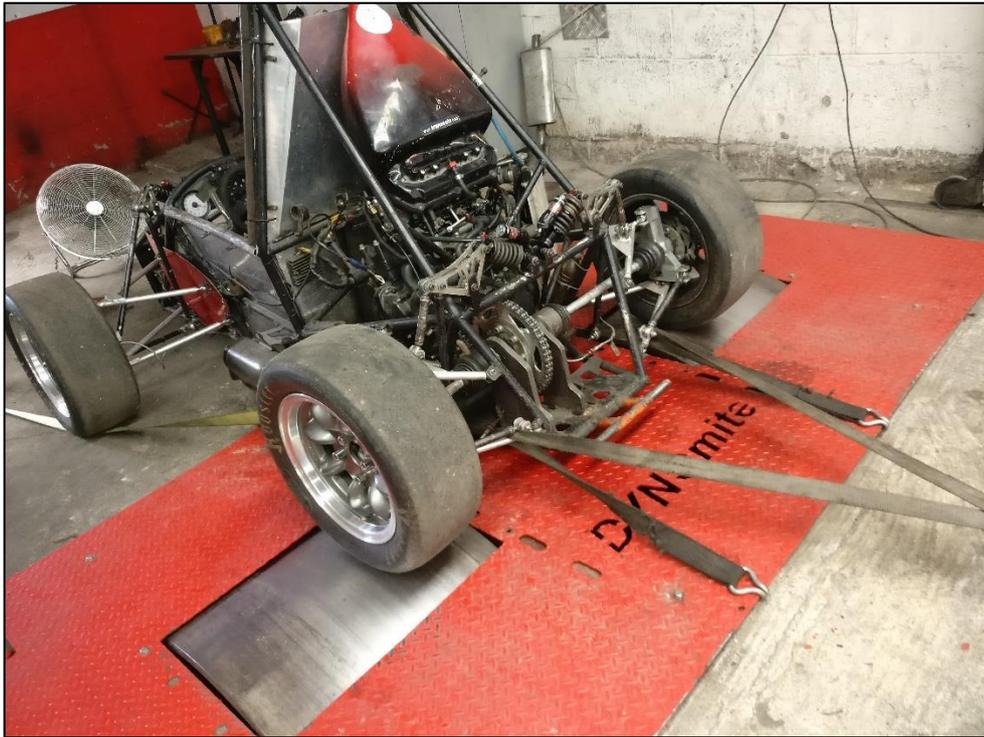
**Figura 80. Vehículo asegurado en los rodillos para la prueba de torque y potencia.**
