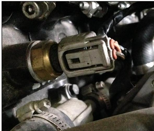
**Figura 28. Sensor de temperatura del agua del motor WTS**
