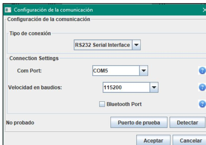
Figura 56. Configuración de comunicación.
