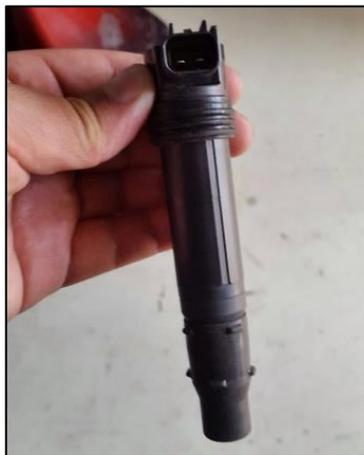
**Figura 31. Bobina de encendido**
