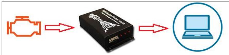
**Figura 52. Conexión Motor – ECU programable - Computador**
