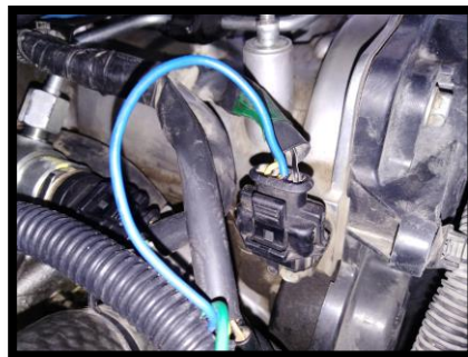
Figura 36. Sensor CMP en el motor.
