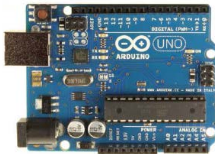
Figura 25. Distribución de pines de tarjeta Arduino Uno
