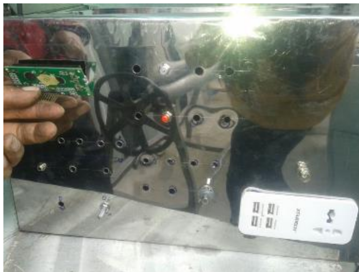
Figura 50. Perforación de la parte frontal del módulo
