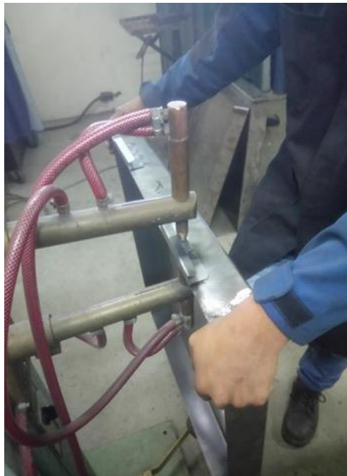
Figura 68 Proceso de soldadura por puntos en las bandejas para cama de agua
