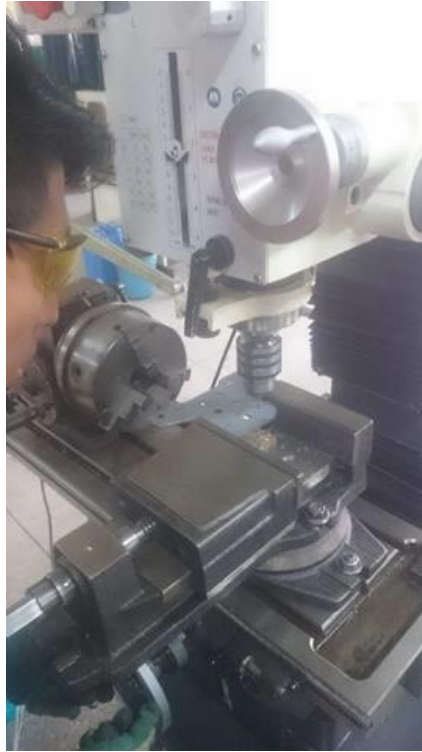
Figura 69 Proceso de fresado en placas para carros de desplazamiento
