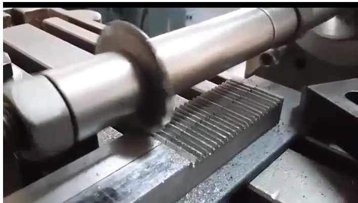
Figura 73 Proceso de manufactura para cremalleras
