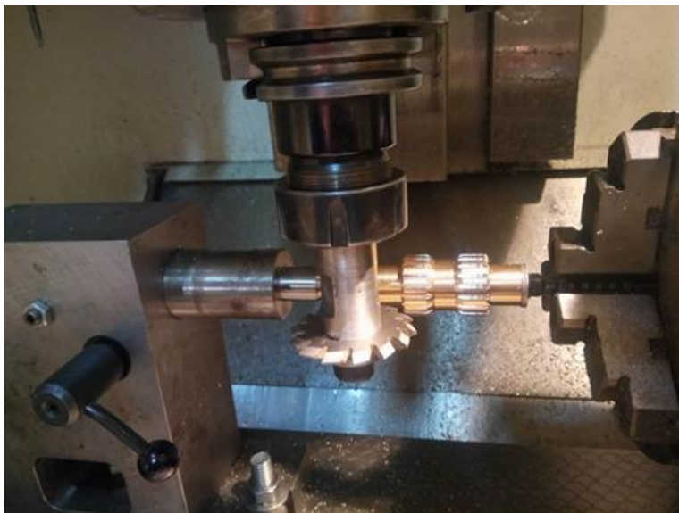
Figura 71 Proceso de fresado para manufactura de piñones
