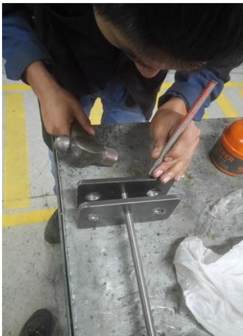
Figura 76 Trazado para proceso de machuelo en elementos del eje Z
