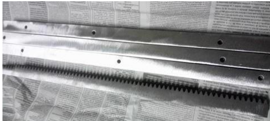
Figura 75 Cremalleras fabricadas con proceso de lijado superficial
