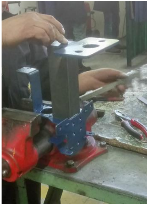
Figura 77 Proceso de soldadura para la sujeción del eje Z
