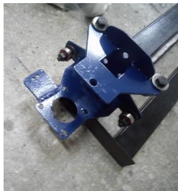
Figura 79 Ensamblaje y ubicación de carros de desplazamiento
