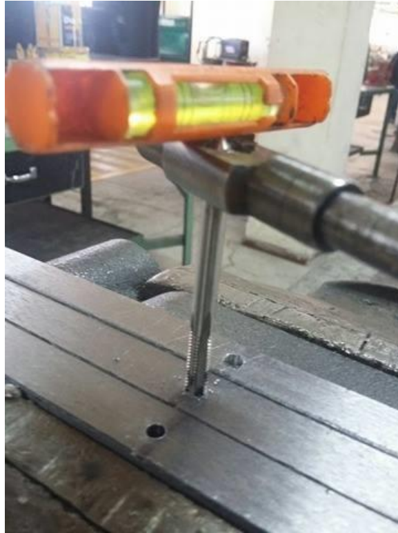
Figura 74 Proceso de manufactura con machuelo para cremalleras
