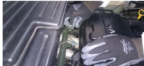
Figura 20. Ubicación de la masa del equipo a una de las terminales del inyector
