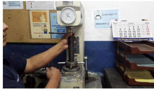
Figura 6 Medición de la dureza de la probeta de torsión
