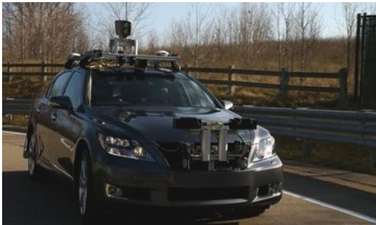
Figura.3. Auto prototipo con sensores frontales para detectar obstáculos y una cámara de largo alcance.
