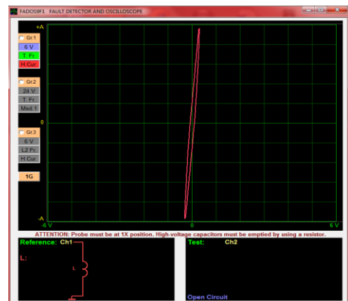
Figura 22. Curva obtenida al realizar el test en el inyector
