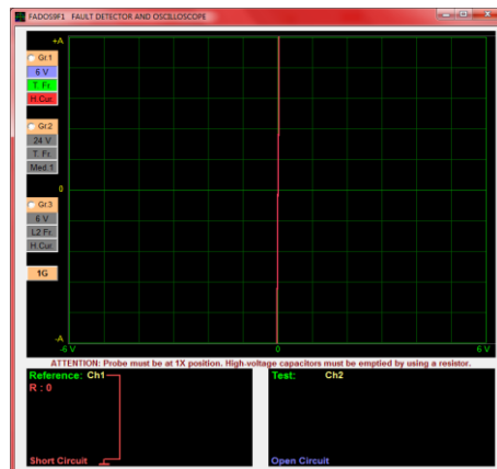
Figura 26. Curva V-I entre las terminales del inyector
