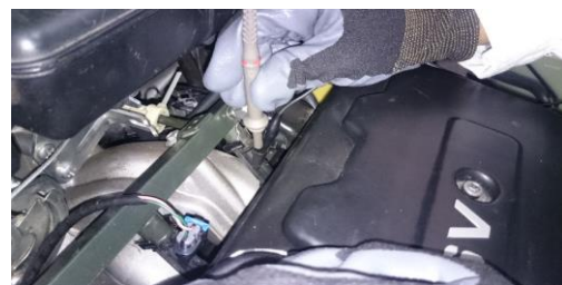
Figura 21. Test con la punta de prueba en el inyector
