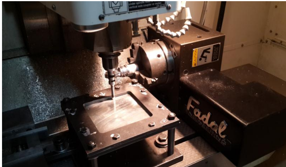
Figura 40. Preparación del equipo CNC para la conformación de la placa
