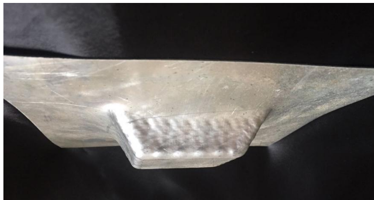
Figura 44: Ensayo 1 vista lateral de la lámina conformada
