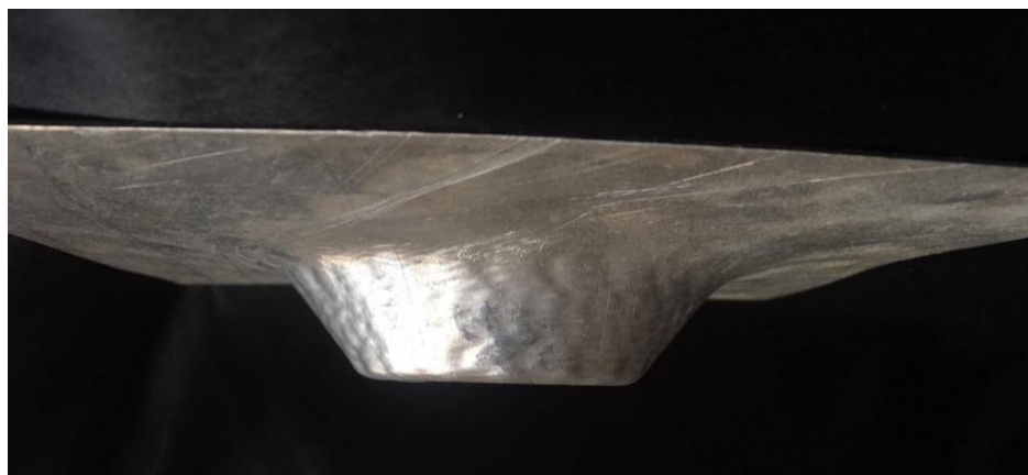
Figura 59: Ensayo 6 vista lateral de la lámina conformada
