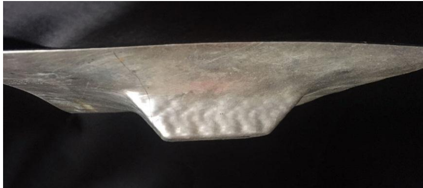
Figura 50: Ensayo 3 vista lateral de la lámina conformada
