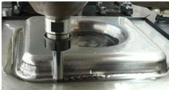
Figura 10: Obtención en AISI 304 de embuticiones con ángulo de inclinación máxima 65°
