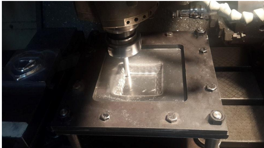
Figura 41: Realización de los ensayos con SPIF
