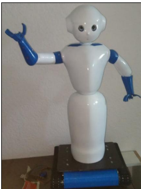
Figura 42. Pintado final de la estructura
