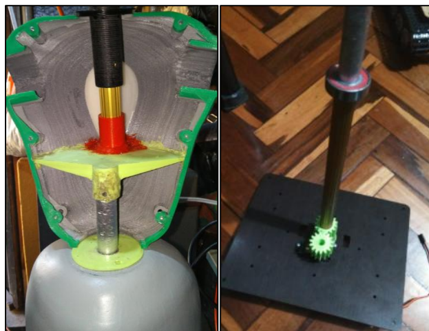
Figura 47. a) Ensamble del tronco a la base b) Varilla que une la base con el tronco
