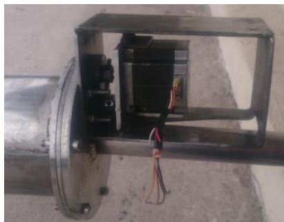
Figura 48 Soporte de motor anclado a brida de sujeción.
