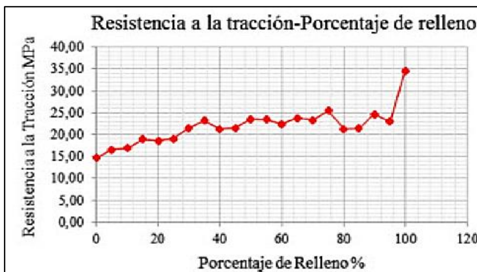
Figura 4 Curva de resistencia a la tracción vs porcentaje de relleno.
