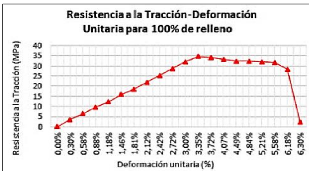
Figura 3 Curva de resistencia a la tracción vs deformación unitaria para 100% de relleno.
