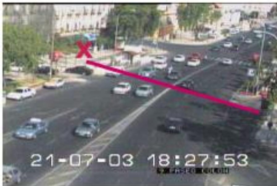
**Figura 18.** Sección transversal para determinar la intensidad
