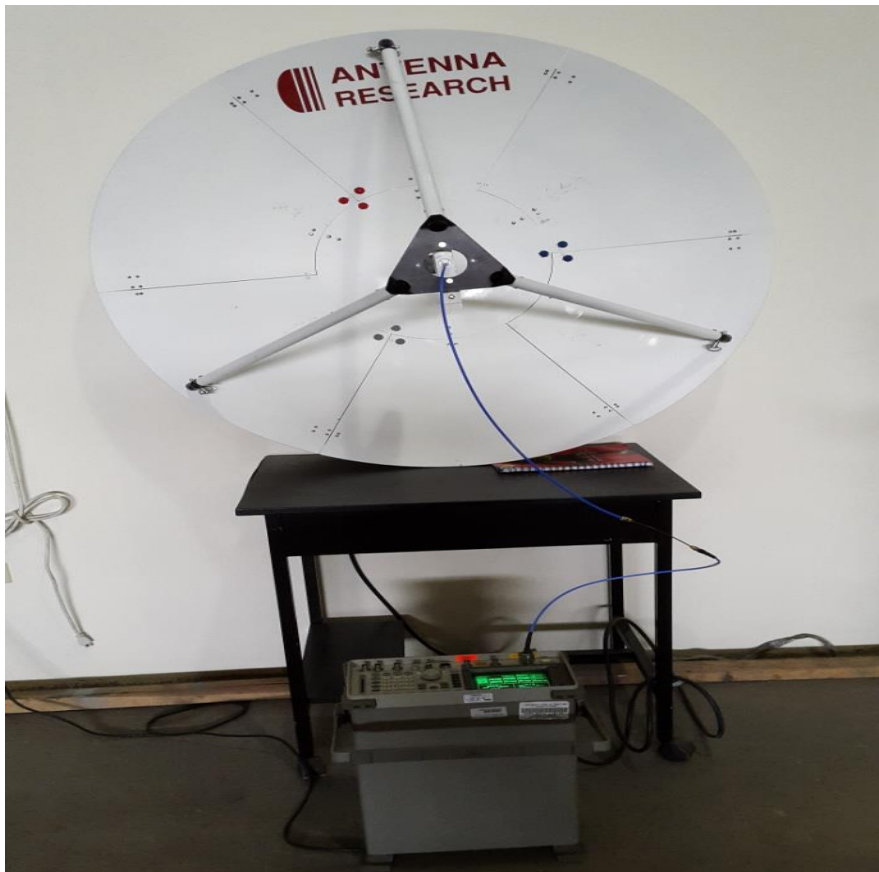
Figura. 32. Equipo (Ant. Log-Periódica con plato parabólico y Generador de señales) para generación de señales.
