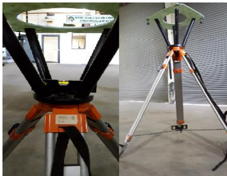
Figura. 30. Nivelando tripode de antena R&S ADD196.
