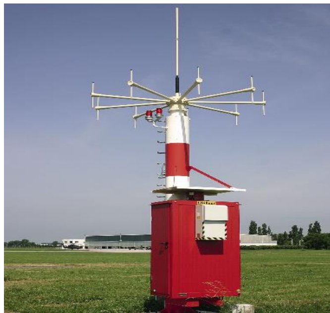
Figura. 2. Ejemplo de arreglo de antenas giratorias.
