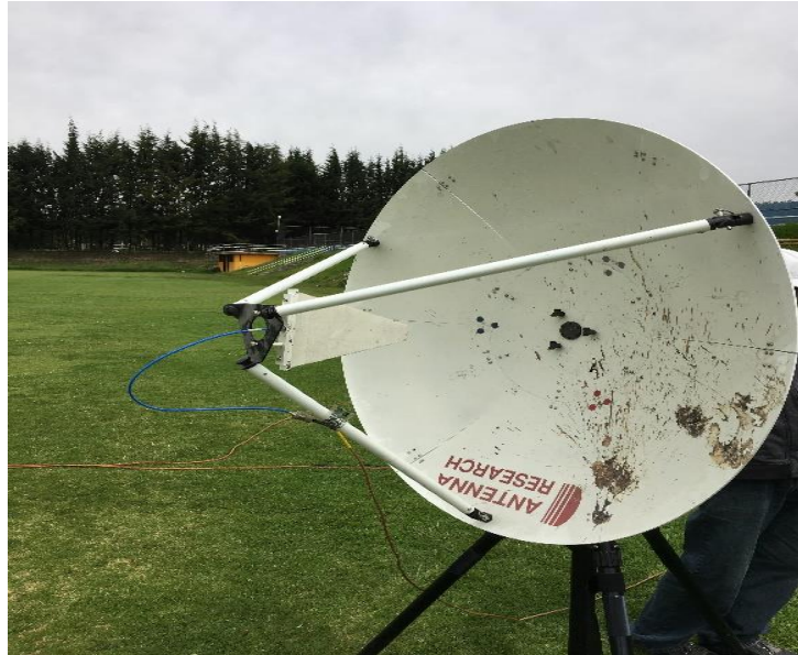
Figura. 46. Equipo transmisor polarizado verticalmente.
