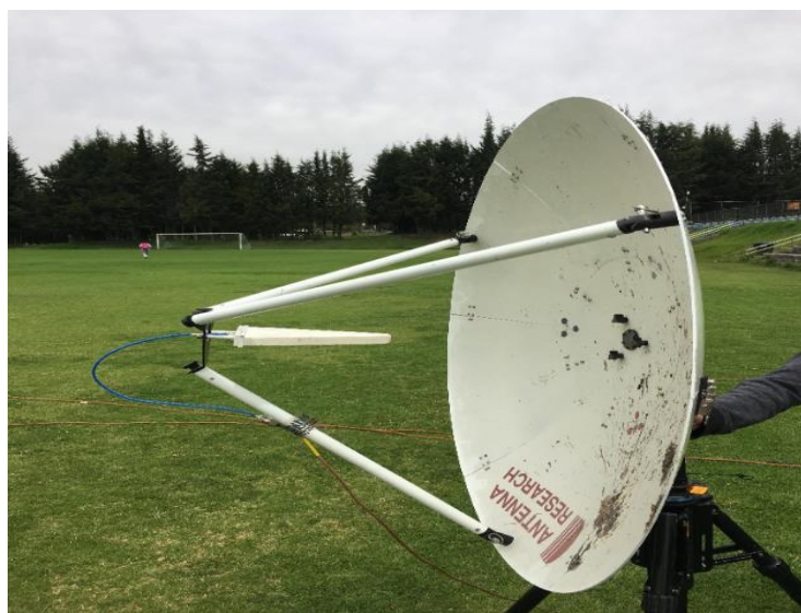
Figura. 45. Equipo transmisor polarizado horizontalmente.
