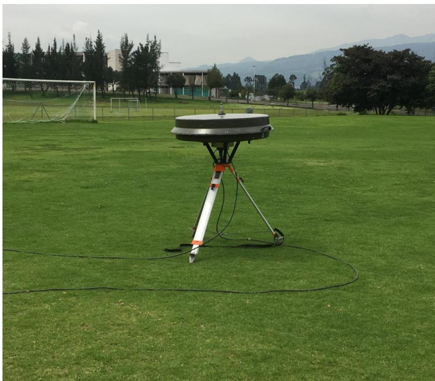
Figura. 27. Estructura externa antena R&S ADD-196.
